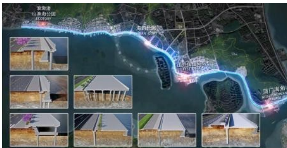
图 2.6.1-1 堤线及断面结构模拟图
